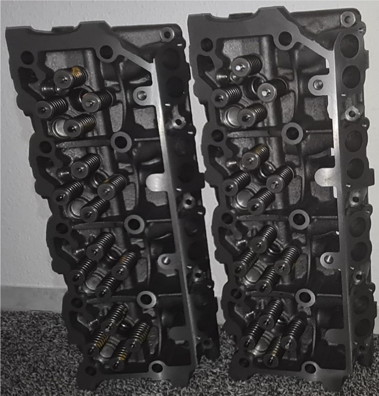
Und hier deutlich zu sehen, die Verstärkungsrippen, welche die Klemmkraft auf die Zylinderkopfdichtung besser verteilen:
